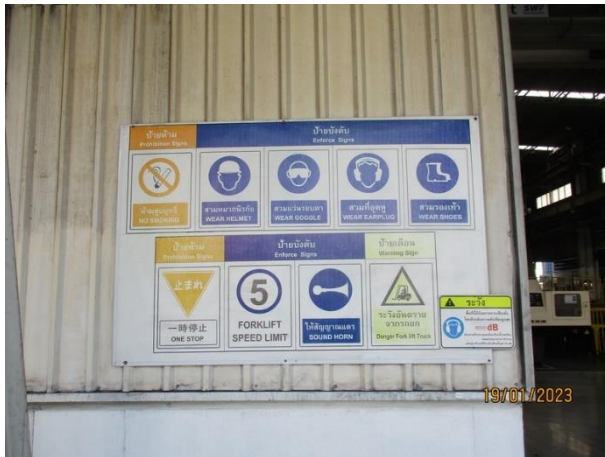
รูปที่ 2-45 ติดตั้งป้ายเตือนหรือสัญลักษณ์ประเภทอุปกรณ์ป้องกันอันตรายส่วนบุคคลที่ต้องสวมใส่บริเวณหน้าประตูทางเข้าบริเวณปฏิบัติงาน
